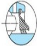
三重密封(后加R3) Triple-lip seal (+Suffix-R3)
