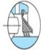
三重密封(后横加R3) Triple-lip seal (+Suffix-R3)
